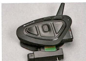
●ヘルメットには付属のクランプを介して取り付ける。簡単に脱着できるため、ツーリングの休憩などでは気軽に取り外して持ち運ぶことができる
