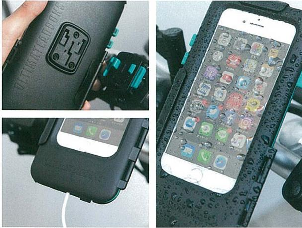
(右) 突然の雨でもスマホをぬらさずに済む防水仕様。5か所のツメで密閉状態をしっかりと保持する (左上) ケースとマウントのジョイントはツメと穴をはめ合わせる方式。工作精度が高いためガタつきがなく、しっかりと固定される (左下) 充電ケーブルやイヤホンケーブルを引き出すためのスリットも設定。ただし、ケーブル接続時は防水対象外なので注意
